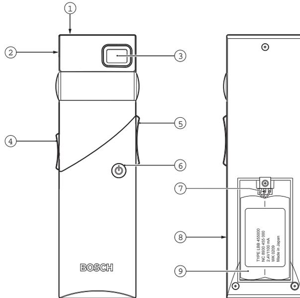
Figure 3.7: Récepteur, vue avant et vue arrière avec compartiment des piles ouvert
