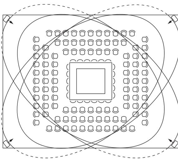
**Figure 4.14:** Disposition des systèmes de diffusion de langues pour couvrir tous les sièges placés en carré
