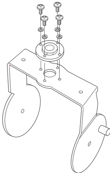
**Figure 5.4:** Fixation de la plaque au support de suspension en cas de montage sur un trépied
