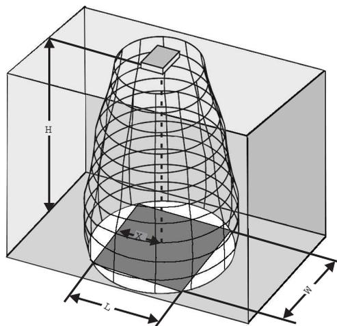
Figure 4.20: Empreinte rectangulaire type pour un angle de montage de 90°
