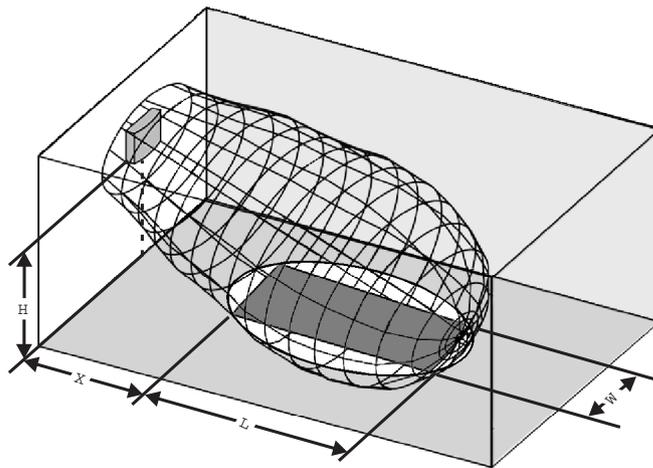
Figure 4.19: Empreinte rectangulaire type pour un angle de montage de 15°
