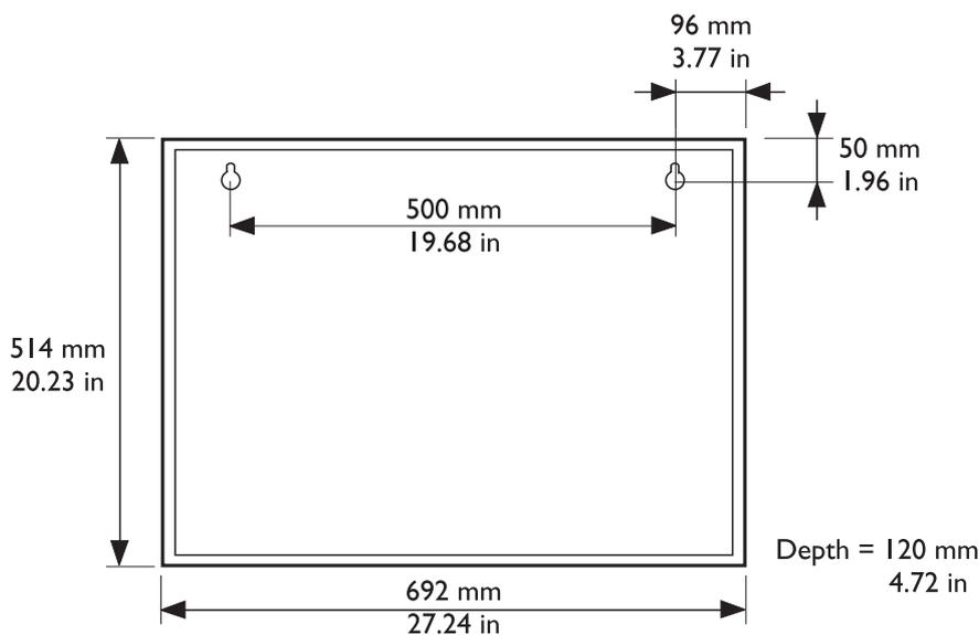
**Figure 5.12:** Dimensions de montage du rack de charge
