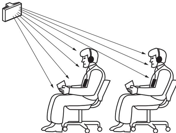
**Figure 4.11:** Signal infrarouge non bloqué par la personne se trouvant devant le participant
