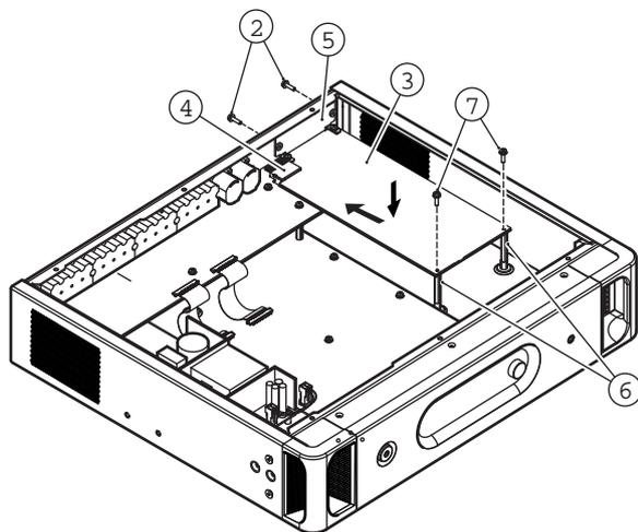
**Figure 5.3:** Montage du module dans le boîtier de l'émetteur
