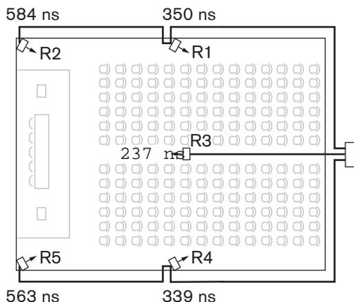
Figure 7.5: Système avec cinq radiateurs et temps de réponse du signal mesurés
