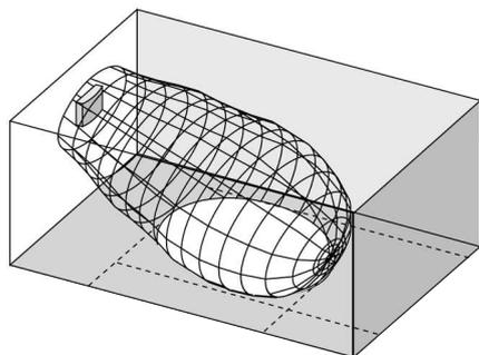
**Figure 4.6:** Système de diffusion de langues fixé à 15° par rapport au plafond
