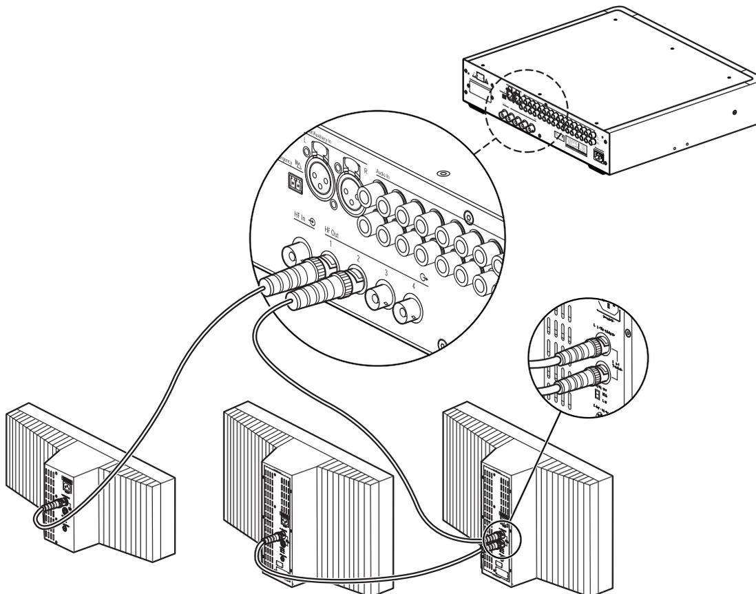
**Figure 6.5:** Connexion par passage en sonde des systèmes de diffusion de langues
