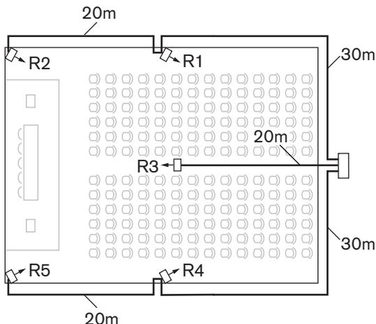
**Figure 7.4:** Système avec cinq radiateurs et longueurs de câble mesurées
