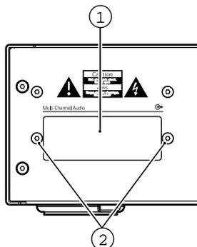
Figure 5.2: Capot protégeant l'emplacement du module
