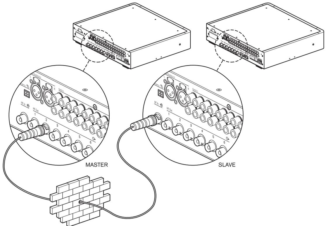
Figure 6.4: Connexion d'un autre émetteur
