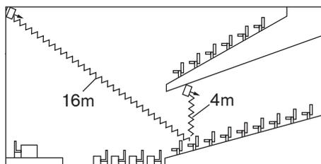
**Figure 7.7:** Différence de longueur du chemin par rayonnement pour deux systèmes de diffusion de langues
