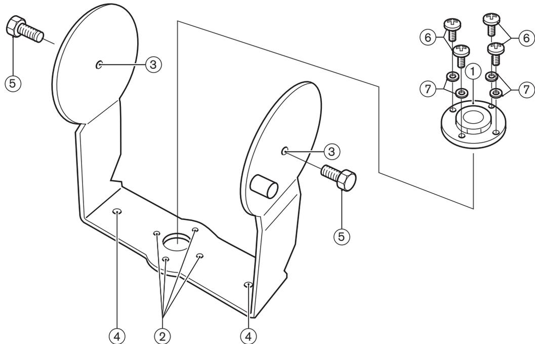
**Figure 3.6:** Support de suspension et plaque de montage des systèmes de diffusion de langues LBB 4511/00 et LBB 4512/00
