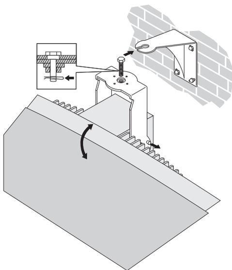
**Figure 5.11:** Fixation du système de diffusion de langues au support de montage mural
