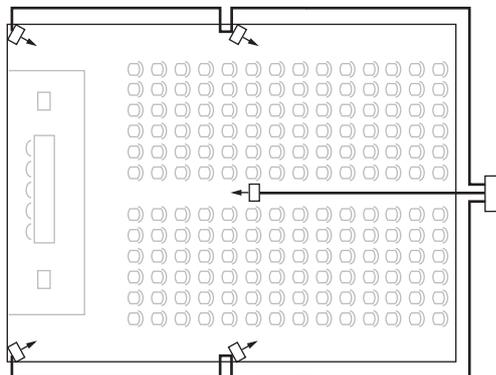
**Figure 4.24:** Disposition symétrique du câblage des systèmes de diffusion de langues (recommandé)
