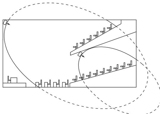
**Figure 4.16:** Systèmes de diffusion de langues couvrant des sièges situés sous un balcon
