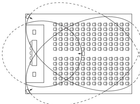
**Figure 4.15:** Disposition des systèmes de diffusion de langues dans une salle de conférence comportant un auditorium et un podium
