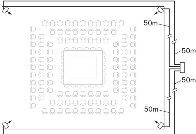
**Figure 4.22:** Systèmes de diffusion de langues comportant des câbles de même longueur
