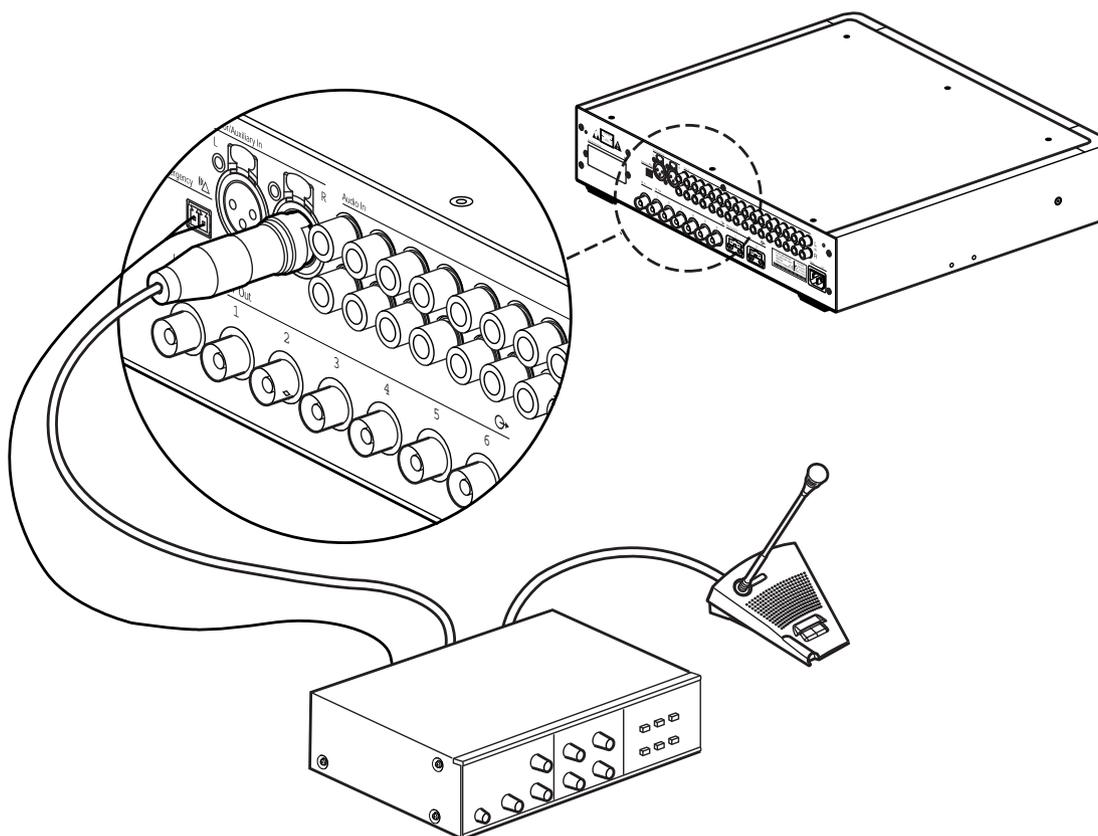
**Figure 6.3:** Connexion d'un signal d'urgence
