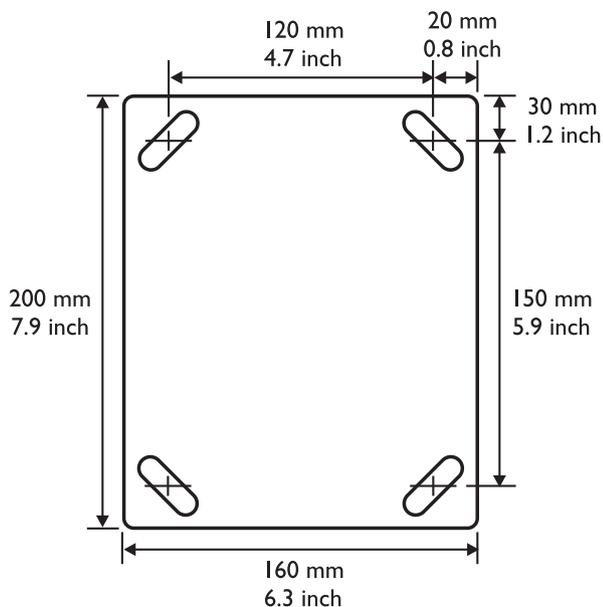
**Figure 5.10:** Support de montage mural LBB 3414/00 avec dimensions et schéma de perçage
