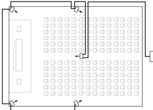
**Figure 4.23:** Disposition asymétrique du câblage des systèmes de diffusion de langues (à éviter)
