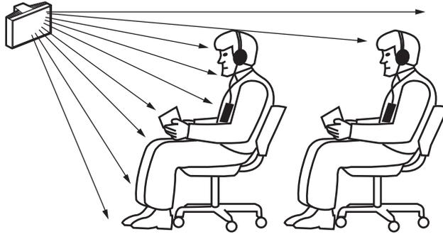
**Figure 4.10:** Signal infrarouge bloqué par la personne se trouvant devant le participant
