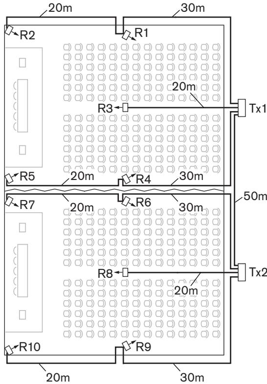
Figure 7.6: Système composé d'émetteurs maître/esclave dans une salle polyvalente
