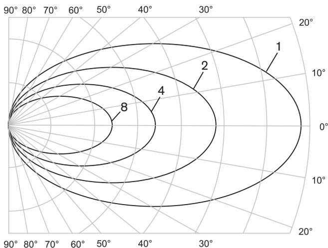
**Figure 4.5:** Diagramme polaire du modèle de rayonnement pour 1, 2, 4 et 8 porteuses
