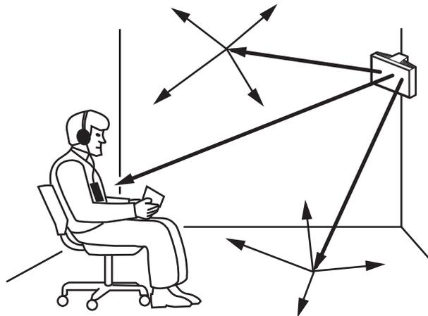
**Figure 4.12:** Combinaison de rayonnement direct et réfléchi
