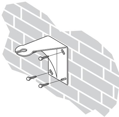
**Figure 5.9:** Fixation d'un support de montage mural au mur
