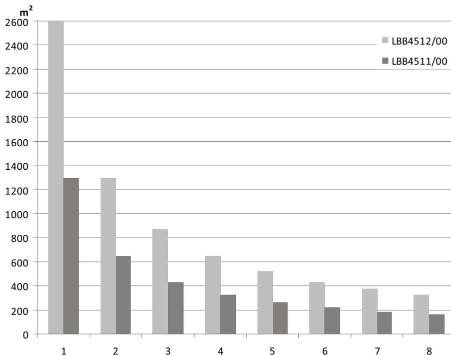
**Figure 4.4:** Zone de couverture totale des systèmes de diffusion de langues LBB 4511/00 et LBB 4512/00 pour 1 à 8 porteuses
