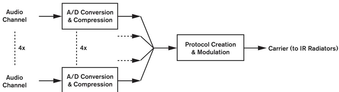
Figure 4.2: Vue d'ensemble du traitement des signaux (pour une porteuse)
