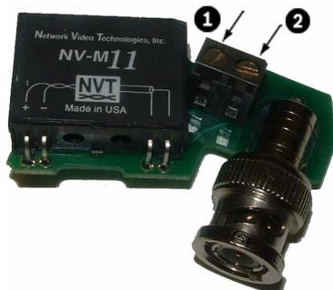
**Figura 4.1** Conecte el cable UTP al transmisor
