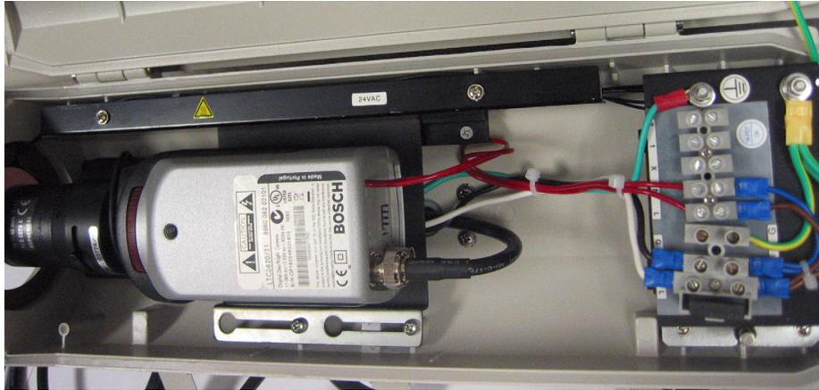
Figura 5.1 Desinstalación del soporte
