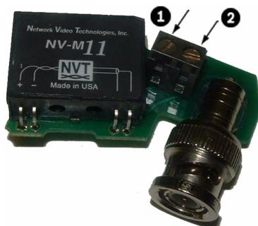
**Figure 4.1** Connectez le câble UTP à l'émetteur
