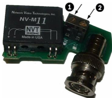
**Figura 4.1** Ligue o cabo UTP ao transmissor.
