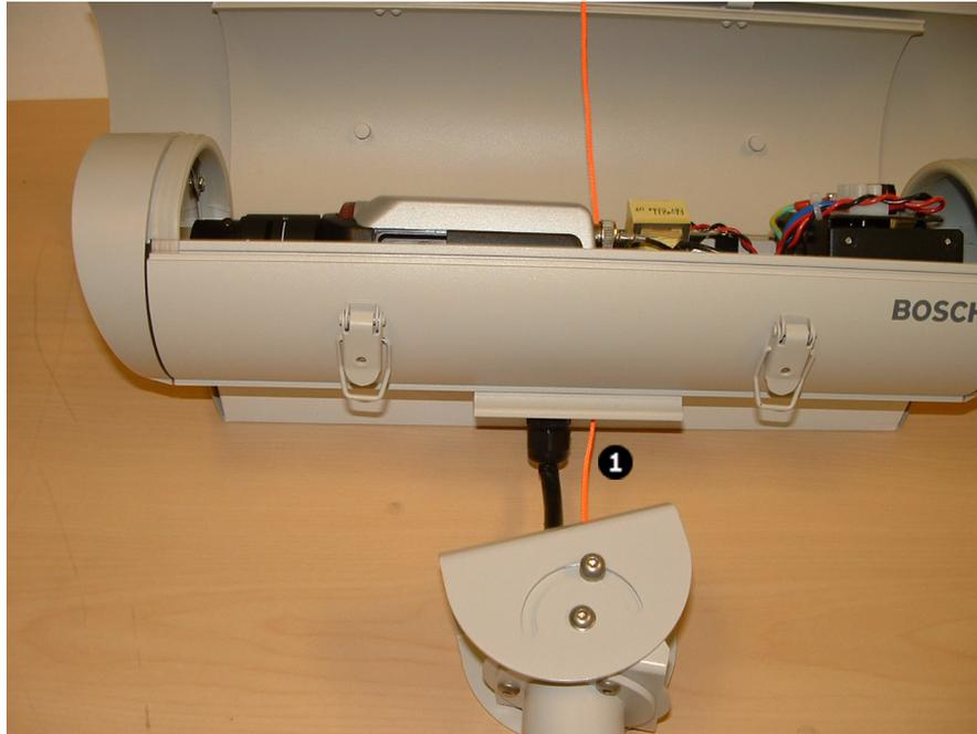
**Figura 4.2** Passe o cordel através do suporte de montagem
