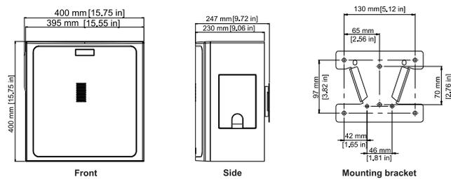
*Subwoofer de montaje en superficie y soporte de montaje*
