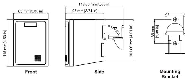
*Altavoz satélite para montaje en superficie y soporte de montaje*
