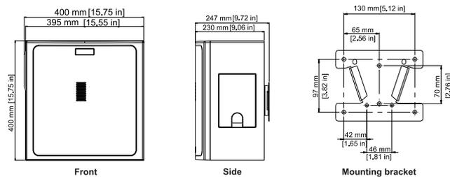
*Subwoofer de montagem em superfície e suporte de montagem*
