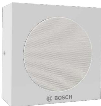
Der LB8-UM06E ist ein universal einsetzbarer, kosteneffizienter 6-W-Aufbaulautsprecher für die Wiedergabe von Sprache und Hintergrundmusik. Geeignet für 100-V-Betrieb mit Leistungsabgriffen zur Anpassung des Schalldruckpegels für die jeweiligen Bereiche. Das robuste, aber ansprechend gestaltete Metallgehäuse bietet Schutz in Umgebungen, in denen Vandalismus ein potenzielles Risiko darstellt.
