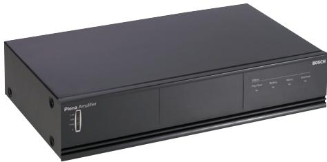
LBB 1930/20 представляет собой усилитель мощностью 120 Вт в корпусе высотой 2U 19" для установки в стойку или настольного использования. Светодиодные индикаторы на передней панели сигнализируют о состоянии усилителя: мощности, уровне выходного аудиосигнала и о функциях контроля. Это высокопроизводительное устройство удовлетворяет самым широким требованиям, предъявляемым к системам оповещения, и имеет необычайно низкую цену.
