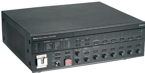
La unidad del controlador de LBB1990/00 Alarma por voz es el núcleo del Sistema de alarma por voz Plena. Se trata del componente principal del Sistema de alarma por voz Plena y posee las funcionalidades básicas para cumplir la norma EN 54-16, incluida la supervisión de todo el sistema, la supervisión de la impedancia de la línea de altavoces, un micrófono de emergencia supervisado ubicado en el panel frontal y un gestor de mensajes supervisados.
