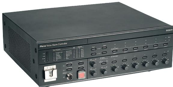
Il controller LBB1990/00 Allarme vocale è il componente principale di Plena Voice Alarm System. Elemento essenziale dell'unità Plena Voice Alarm System, il controller è un'unità dotata di tutte le funzionalità principali, conformi allo standard EN 54-16, incluso il monitoraggio dell'intero sistema, dell'impedenza della linea degli altoparlanti e del microfono di emergenza sul pannello anteriore, nonché dell'unità di gestione dei messaggi.
