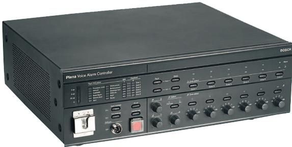
Блок контроллера LBB1990/00 Аварийное оповещение является главным компонентом системы Система речевого и аварийного оповещения Plena. Он является основой Система речевого и аварийного оповещения Plena и соответствует требованиям стандарта EN 54-16, включая мониторинг работоспособности системы, контроль целостности линий громкоговорителей, микрофон для тревожных объявлений на передней панели и менеджер сообщений.
