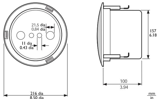
Abmessungen des LBC 3086/41 mit LBC 3081/02 Feuerschutzhaube (in mm/Zoll)
