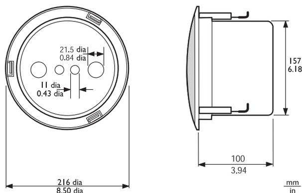
Размеры в мм (дюймах) комплекта с противопожарным куполом LBC3086/41 + LBC 3081/02
