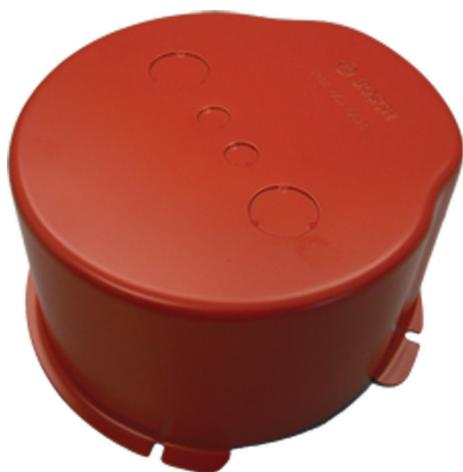
In caso di incendio, la cavità del soffitto può consentire la propagazione delle fiamme o del fumo nell'edificio. Per impedire la propagazione del fuoco attraverso questa cavità, è possibile proteggerla con una dome antincendio in acciaio (LBC 3080/01). Questa dome opzionale viene montata sul gruppo altoparlante con quattro viti autofilettanti in dotazione. I fori premistoppa della dome sono quattro: due per i passafilo (in dotazione) e due per i premistoppa per cavi (PG 13).
