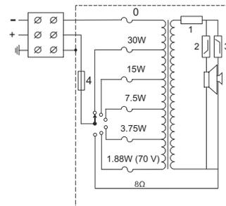
Schaltdiagramm (1: passiver Begrenzer, 2: Tiefpassfilter, 3: Hochpassfilter, 4: thermische Sicherung)
