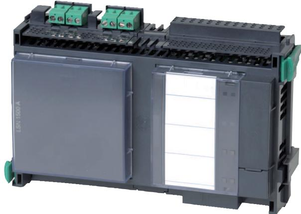
Ovaj modul omogućuje povezivanje LSN petlje s do 254 elementa LSN improved maksimalne električne struje linije od 1500 mA ili do 127 elemenata LSN classic maksimalne električne struje linije od 300 mA.
