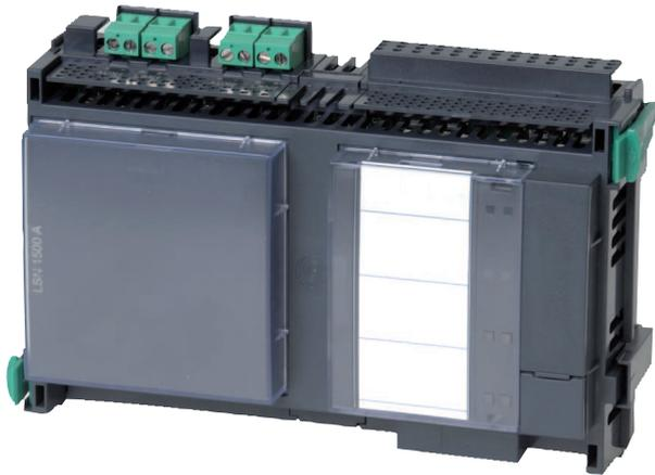
Questo modulo consente il collegamento di un loop LSN a un massimo di 254 elementi LSN improved con corrente di linea fino a 1500 mA o a un massimo di 127 elementi LSN standard con corrente di linea fino a 300 mA.
