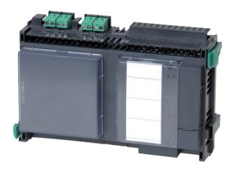
Этот модуль обеспечивает подключение шлейфа LSN с 254 элементами LSN improved с максимальным общим током 1500 мА или 127 стандартных элементов LSN с максимальным общим током 300 мА.
