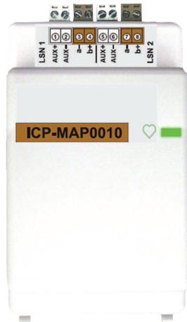
Jedes LSN Gateway-Modul verbindet einen LSN-Ring (Local Security Network) oder ein bis zwei Stichleitungen mit einem maximalen Ausgangsstrom von 300 mA. Jedes Modul unterstützt bis zu 127 LSN-Geräte.
