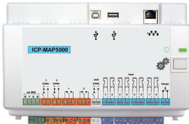
Avec un bus de données Bosch (BDB) basé sur la technologie Controller Area Network (CAN) comme bus interne et externe, la centrale intègre une gamme d'applications dans le cadre du système évolutif Modular Alarm Platform 5000.
