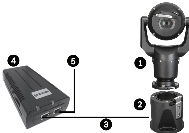
Figur 12.1: Typisk IP-konfiguration med 95 W midspan (ingen I/O-tilslutninger)
