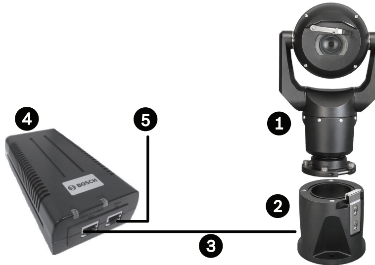
Figure 12.1: Configuration IP standard avec Injecteur 95 W (pas de connexion E/S)
