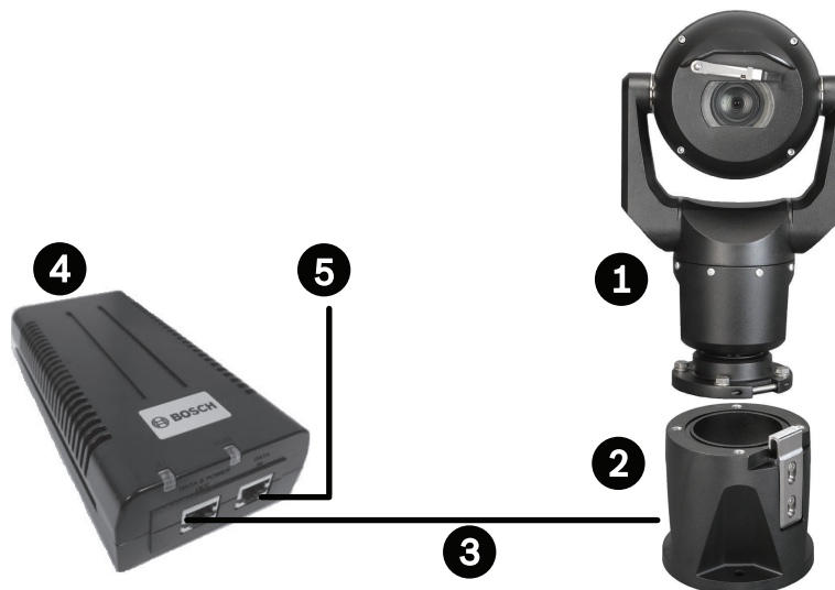
Figur 12.1: Vanlig IP-konfigurasjon med 95 W midspan (ingen I/U-tilkoblinger)
