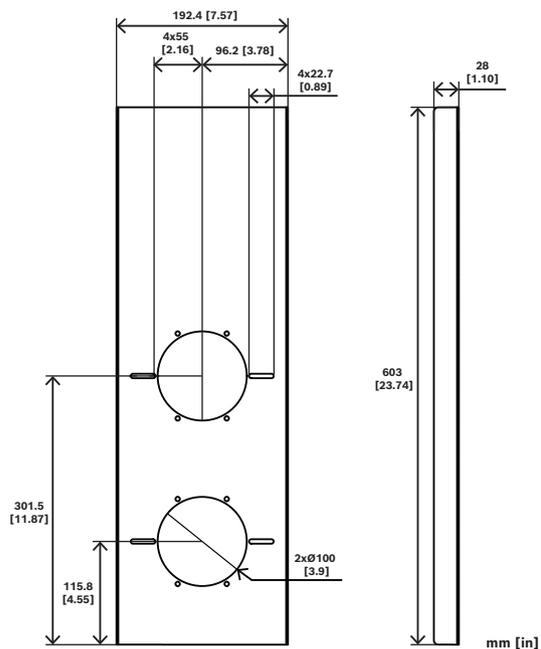
Abb. 1: MNT-ICP-FDC – Abmessungen
