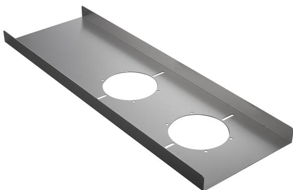
Il kit di supporto a soffitto per sospensione MNT-ICP-FDC incorpora un design a ponte portante che elimina l'abbassamento delle piastrelle distribuendo uniformemente il peso della telecamera sul sistema di supporto a soffitto. Il design a ponte è anche più veloce e più semplice da installare rispetto ai tradizionali supporti per telecamere profilati a T. Il kit include tutto l'hardware necessario per montare le telecamere supportate.
