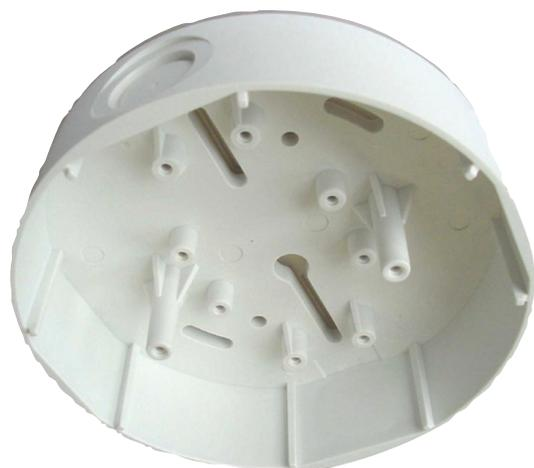
Der Zusatzsockel MSC 420 wurde speziell für a.P.-Kabelzuführung durch Kabelschutzrohre konzipiert und verfügt über zwei gegenüberliegende, vorgestanzte Eingänge mit 20 mm Durchmesser sowie über zwei weitere gegenüberliegende und vorbereitete Eingänge für bis zu 28 mm Durchmesser.
