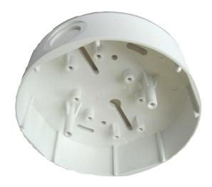
A Base Adicional MSC 420 foi concebida especialmente para entradas de cabo pela lateral com canalizações eléctricas e possui 2 entradas opostas preparadas com 20 mm de diâmetro e mais 2 entradas opostas preparadas para diâmetros até 28 mm.
