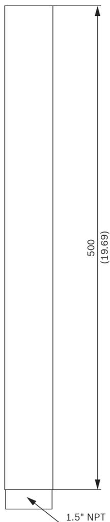
Рис. 1: Размеры NDA-U-PMTE (длинная удлинительная труба)
