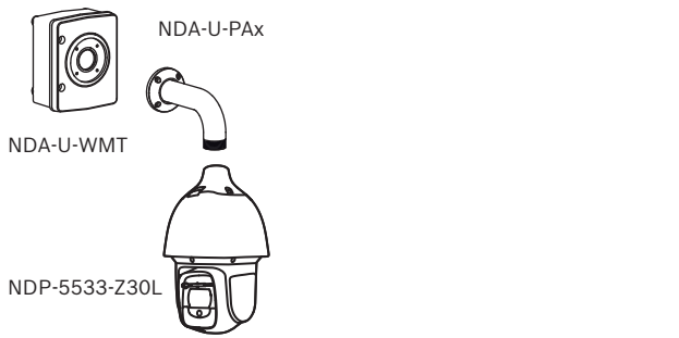
图片 1: 带监控电源盒的墙壁安装底座(IP66)
