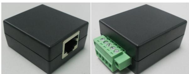
Abbildung 6.2: Mikrofonadapter
