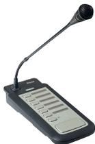
Die PLN-6CS Sprechstelle dient zur Übertragung von Durchsagen an vordefinierte Zonen des All-in-One-Systems. Maximal sechs Sprechstellen können unter Verwendung von Cat-5-Kabeln mit RJ45-Steckern über eine Verkettungskonfiguration mit dem All-in-One-Gerät verbunden werden.
