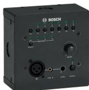
La console murale PLN-4S6Z est utilisée pour contrôler à distance l'appareil tout-en-un. Il est relié à l'appareil tout-en-un à l'aide d'un câble Cat-5 terminé par des connecteurs RJ45.
