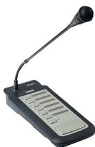
Le pupitre d'appel PLN-6CS est un appareil à distance qui permet d'envoyer des annonces à des zones sélectionnées du système tout-en-un. Il est possible de connecter un maximum de six pupitres d'appel à l'appareil tout-en-un dans une configuration en bus à l'aide de câbles CAT-5 terminés par des connecteurs RJ45.
