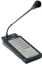
Stasiun Panggilan PLN-6CS merupakan perangkat jauh untuk membuat pengumuman ke zona yang dipilih dalam Sistem All-in-One. Maksimal enam Stasiun Panggilan dapat disambungkan dalam konfigurasi rantai daisy ke Unit All-in-One menggunakan kabel Cat-5 yang diputus dengan konektor RJ45.
