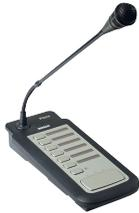
PLN-6CS 콜 스테이션은 올인원 시스템의 선택 구역에 안내 방송을 할 때 사용하는 원격 장치입니다. RJ45 커넥터로 종단처리된 Cat-5 케이블을 이용해 올인원 장치에 데이터 체인 구성으로 연결할 수 있는 콜스테이션은 최대 6개입니다.
