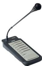
A consola de chamada PLN-6CS é um dispositivo remoto com o qual poderá fazer anúncios para zonas seleccionadas do sistema tudo-em-um. É possível ligar, no máximo, seis consolas de chamada à unidade tudo-em-um numa configuração em cadeia, utilizando cabos Cat-5 com conectores RJ45.
