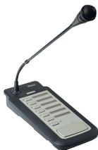
该PLN-6CS呼叫站是一个远程设备，用于向一体机系统的所选区域进行广播。通过使用端部带RJ45连接器的Cat-5电缆，可在菊花链配置中将最多6个呼叫站连接到一体机装置。
