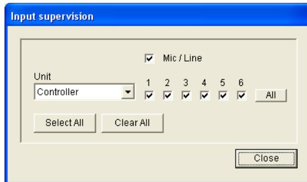
**Bild 4.12** Eigenschaftensblatt „Input Supervision“ (Eingangsüberwachung)
