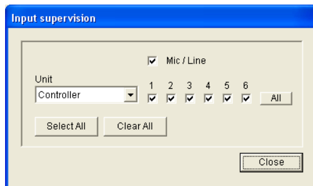
Figure 4.12 Fenêtre de propriétés « Contrôle d'entrée » (Input supervision)
