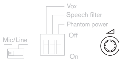
Vyobrazení 6.5: Regulátor hlasitosti funkce VOX
