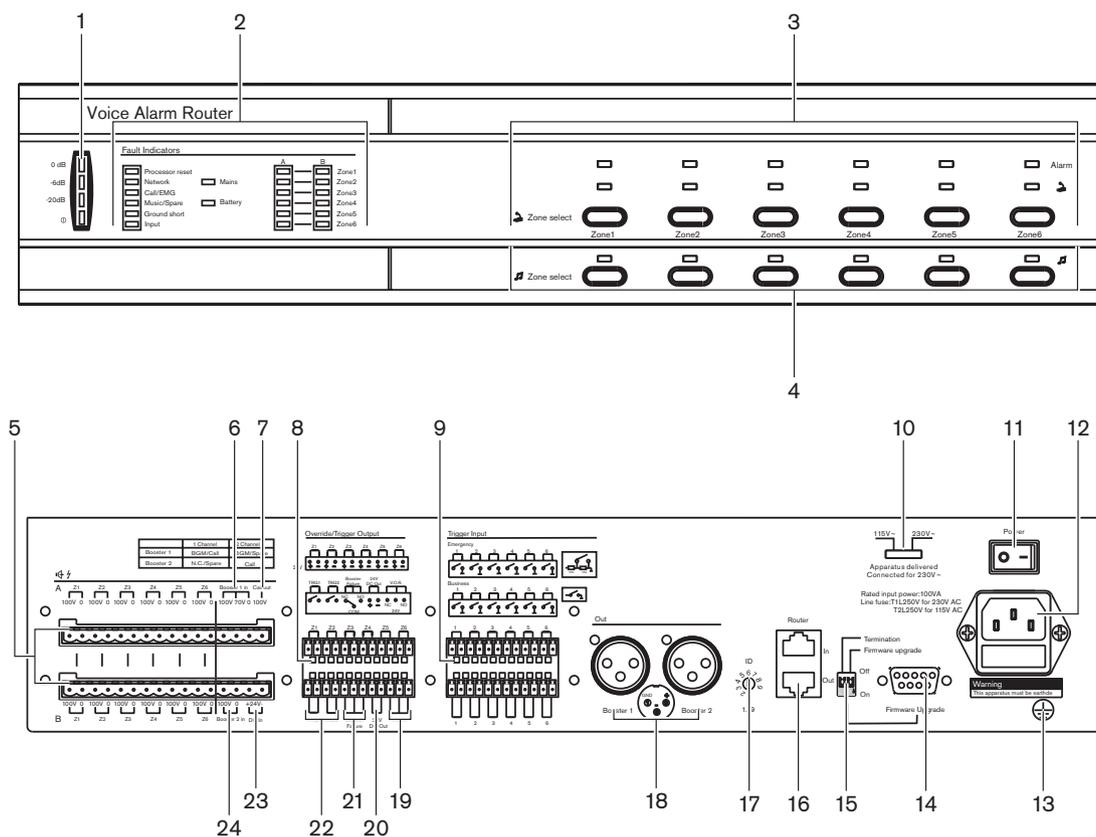
**Figure 3.4:** Vues de face et de dos du routeur d'alarme vocale.
