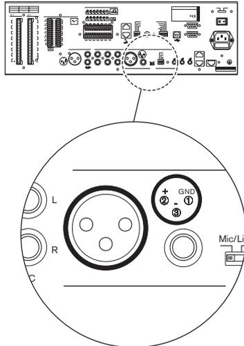
Figure 5.12: Entrée mic/ligne avec fonctionnalité VOX
