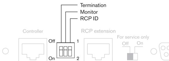
**Figure 6.8:** Paramètres de commande à distance
