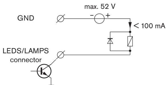
Figure 5.28: Connexion des relais
