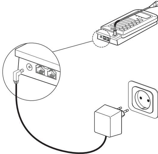
Figure 5.23: Raccordement d'une alimentation
