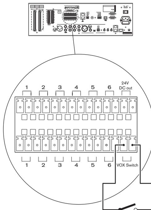
Figure 5.13: Connexion d'un interrupteur VOX
