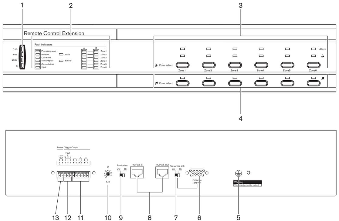
Figure 3.11: Vues de face et de dos de l'extension de la commande à distance
