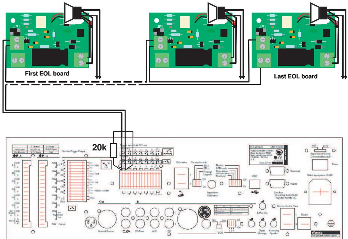
**Figure 4.5:** Indication d'entrée de commande
