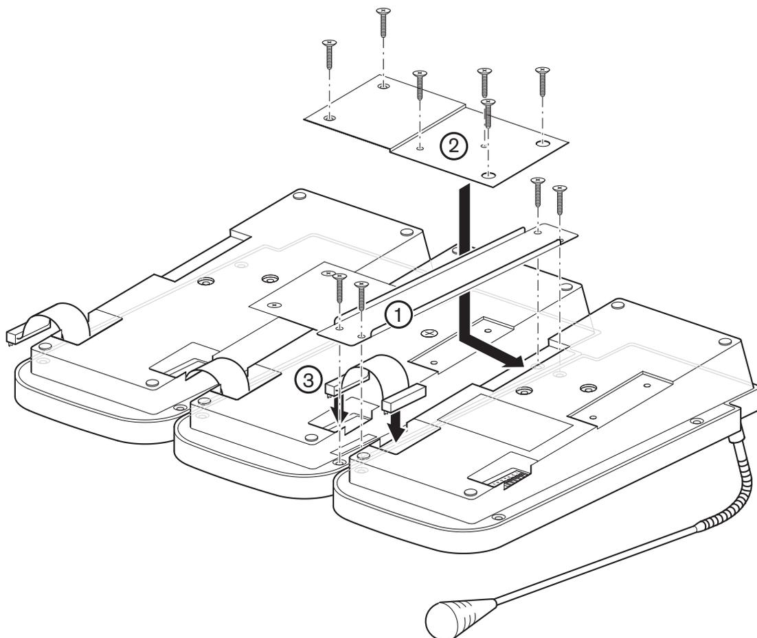
Figure 4.2: Connexion des claviers pour pupitres d'appel
