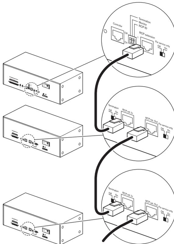
Figure 5.24: Connexion des extensions de commande à distance
