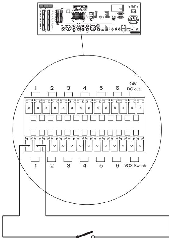
Figure 5.20: Connexion des entrées de commande normales
