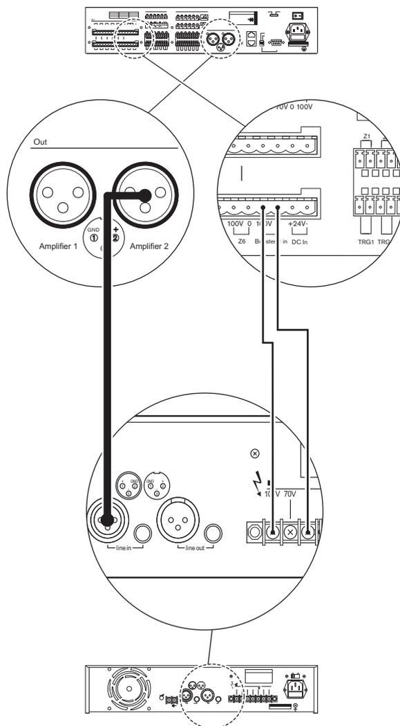
Figure 5.22: Connexion d'un amplificateur de puissance externe 2
