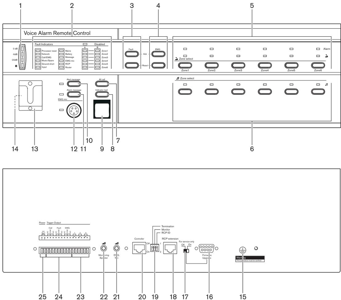
Figure 3.9: Vues de face et de dos de la commande à distance du système de sonorisation et d'évacuation
