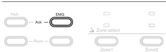
Figure 7.9: Touche d'acquiescement d'urgence (EMG Ack)
