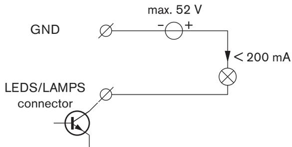
Figure 5.27: Connexion des lampes
