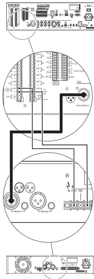
**Figure 5.4:** Connexion d'un amplificateur de puissance externe
