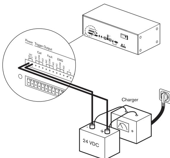
Figure 5.29: Raccordement d'une alimentation
