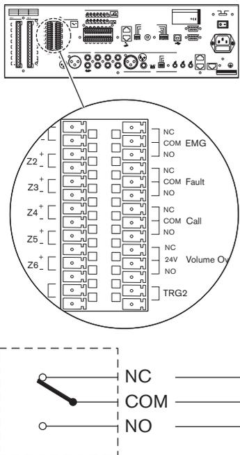
Figure 5.15: Contacts de sortie d'état (par défaut)
