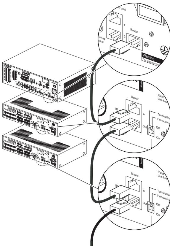
**Figure 5.3:** Connexion des routeurs
