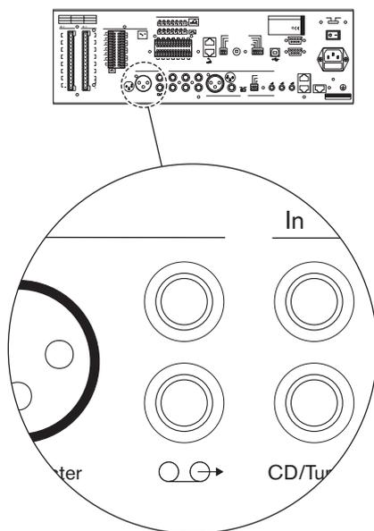
Figure 5.11: Sortie de ligne
