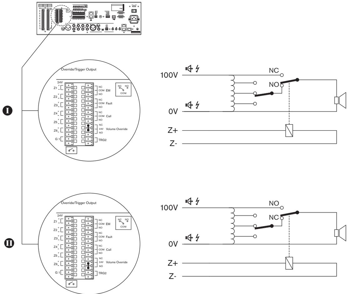
**Figure 5.9:** Neutralisation de volume à 4 fils
