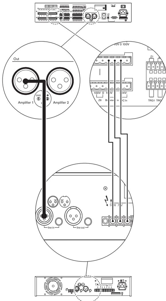
**Figure 5.21:** Connexion d'un amplificateur de puissance externe 1
