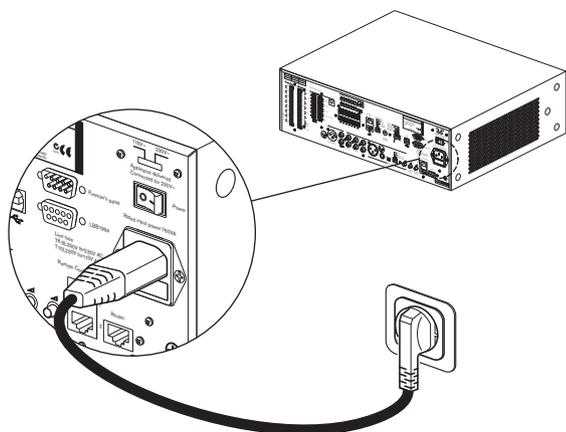
Figure 5.17: Raccordement du cordon d'alimentation secteur
