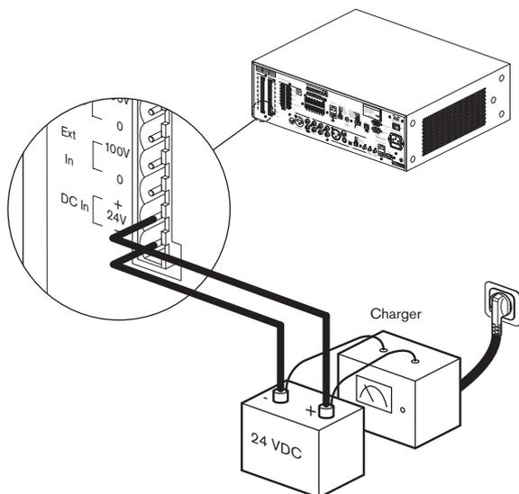
Figure 5.18: Raccordement de l'alimentation de secours
