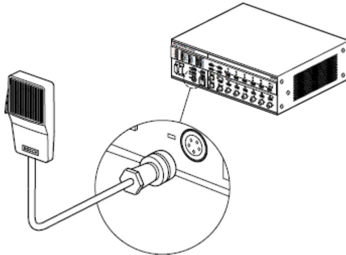
**Figure 5.1:** Connexion du microphone d'urgence
