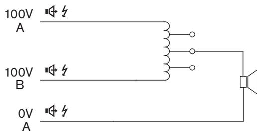
Figure 5.10: Neutralisation de volume à 3 fils
