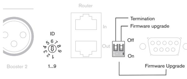
**Figure 6.6:** Paramètres du routeur
