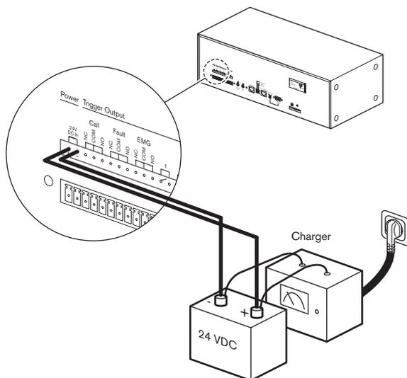
Figure 5.25: Connexion d'une alimentation 24 VCC
