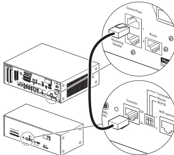
**Figure 5.5:** Connexion d'une télécommande
