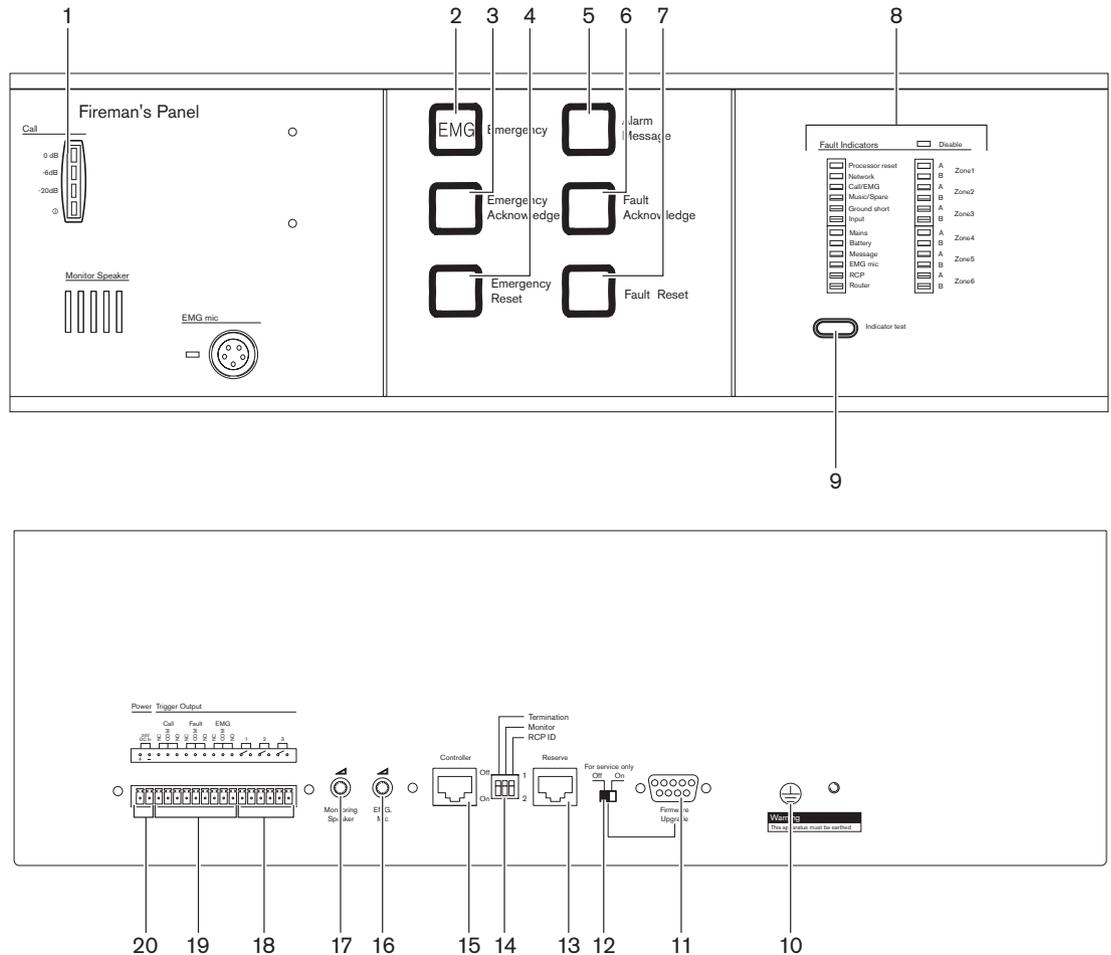
Figure 3.13: Vues de face et de dos de la console pompier
