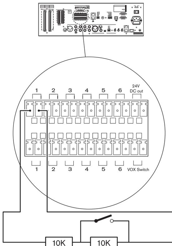
Figure 5.19: Connexion des entrées de commande d'urgence
