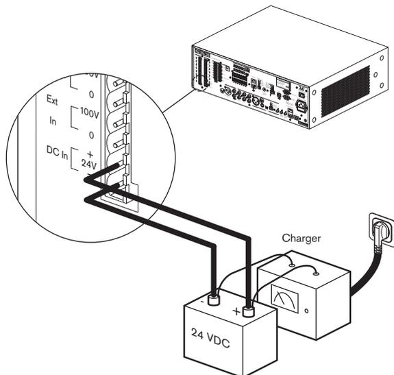
**Figura 5.18:** Collegamento di un alimentatore di backup
