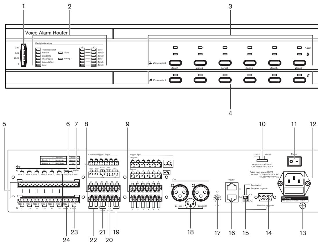
**Figura 3.4:** Vista frontale e posteriore del router per allarmi vocali
