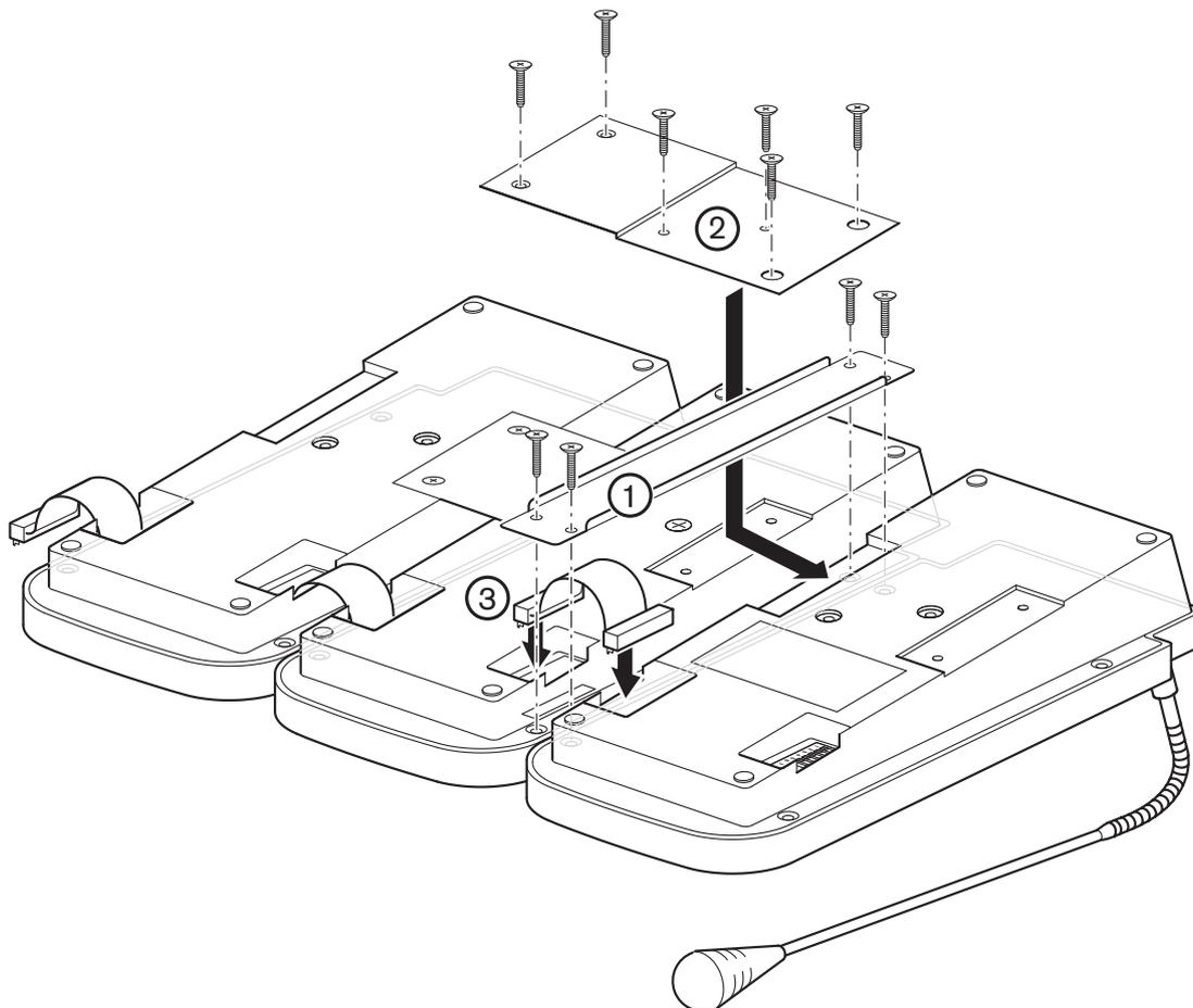
**Figura 4.2:** Collegamento delle tastiere per postazioni annunci
