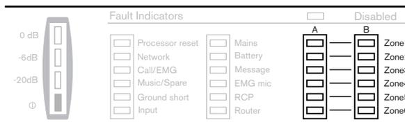
**Figura 7.22:** Indicatori delle linee altoparlanti
