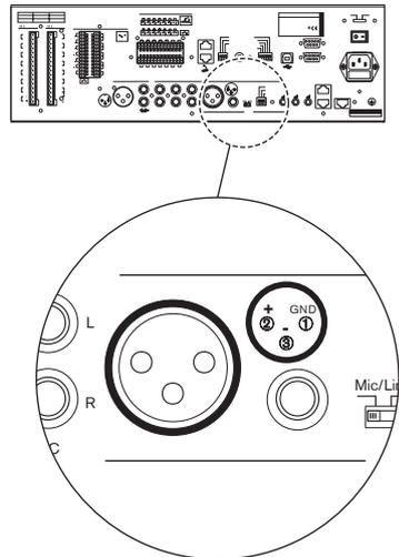
Figura 5.12: Ingresso Microfono / linea con funzionalità VOX
