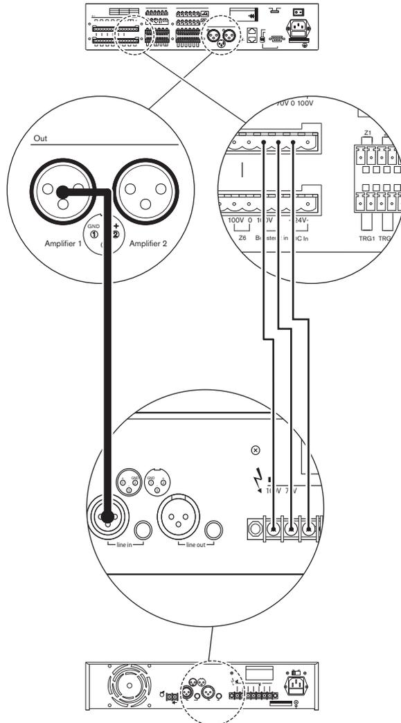
**Figura 5.21:** Collegamento dell'amplificatore di potenza esterno 1
