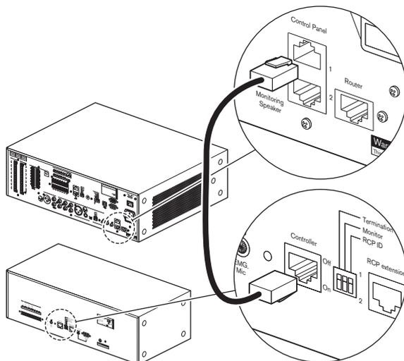
**Figura 5.5:** Collegamento di un'unità di controllo a distanza
