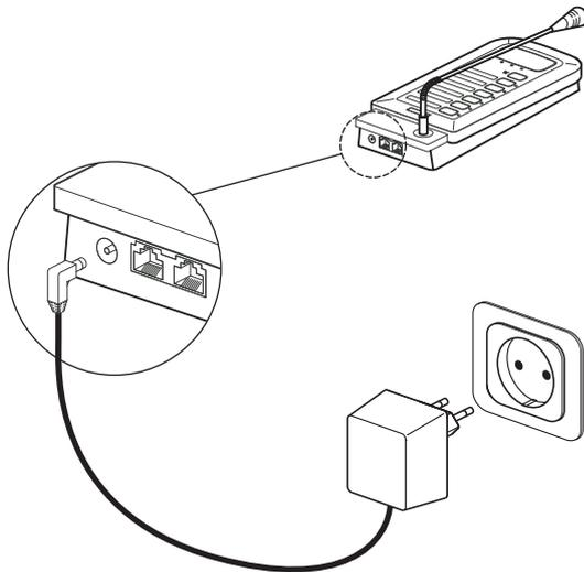
Figura 5.23: Collegamento di un alimentatore
