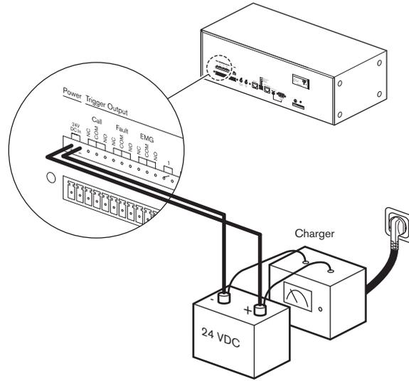
Figura 5.25: collegamento di un alimentatore a 24 VDC
