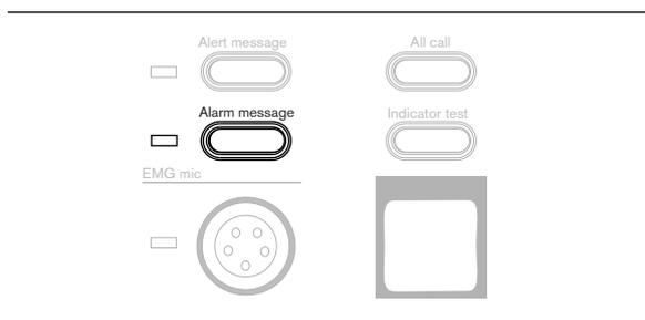
**Figura 7.18:** Pulsante Alarm message (Messaggio di allarme)
