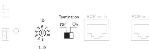
**Figura 6.9:** Impostazioni dell'unità di controllo a distanza
