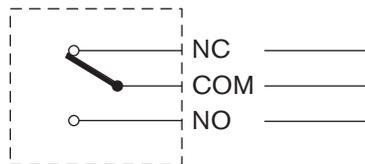
**Figura 5.15:** Contatti di uscita di stato (predefiniti)
