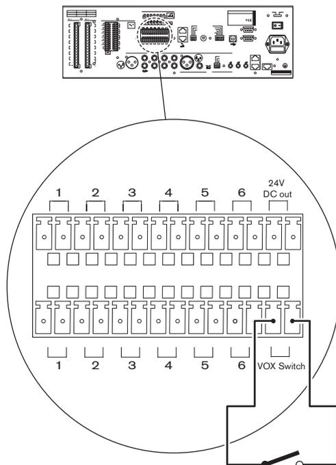
Figura 5.13: Collegamento di un interruttore VOX
