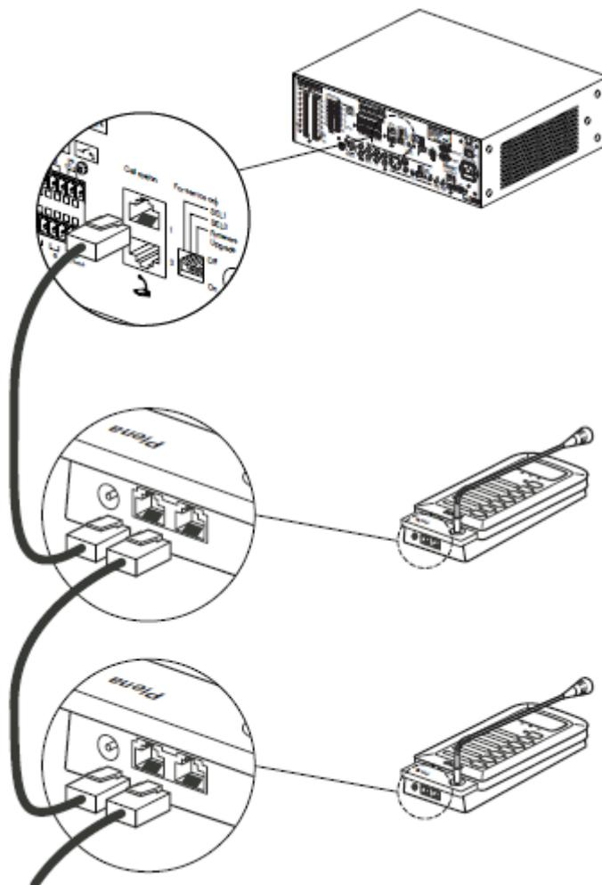
**Figura 5.2:** Collegamento delle postazioni annunci
