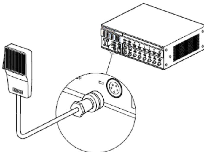
**Figura 5.1:** Collegamento del microfono di emergenza
