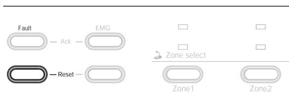
**Figura 7.20:** Pulsante Fault Reset (Azzeramento guasto)
