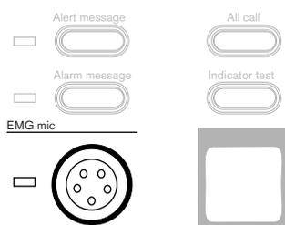
Figura 7.14: Indicatore del microfono di emergenza
