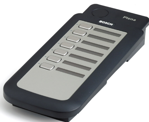
Rysunek 3.6: Klawiatura stacji wywoławczej
