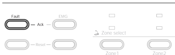
图片 7.19: Fault Ack（故障确认）按钮
