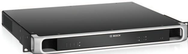
这是一款灵活紧凑的多通道功率放大器，可用在公共广播和语音报警应用场合中的100 V或70 V扬声器系统中。它可融入集中式系统拓扑中，但是也支持分散式系统拓扑，这得益于OMNEO IP网络连接以及由多功能电源提供的直流电。每个放大器通道的输出功率会根据连接的扬声器负载调节，仅受限于整个放大器的总功率预算。与采用传统放大器相比，得益于这种灵活性以及可与备用放大器通道集成这一特性，可以高效地使用可用功率，在扬声器负载相同时，使用的放大器数量更少。
