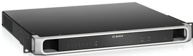
这是一款灵活紧凑的多通道功率放大器，可用在公共广播和语音报警应用场合中的100 V或70 V扬声器系统中。它可融入集中式系统拓扑中，但是也支持分散式系统拓扑，这得益于OMNEO IP网络连接以及由多功能电源提供的直流电。每个放大器通道的输出功率会根据连接的扬声器负载调节，仅受限于整个放大器的总功率预算。与采用传统放大器相比，得益于这种灵活性以及可与备用放大器通道集成这一特性，可以高效地使用可用功率，在扬声器负载相同时，使用的放大器数量更少。数字声音处理和控制可根据每个分区的音响效果和要求进行调节，因此，音质更佳，语音清晰度更高。
