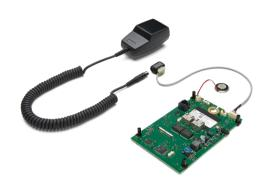
基本型呼叫站套件是開放式架構的呼叫站,可為 PRAESENSA公共廣播與緊急警報系統建立專用的全訂製操 作面板。其功能和PRA-CSLW相同,但是不含 LCD 使用者 介面,以使操作者桌面安裝或壁掛式消防的面板壁板安裝更 簡便。
