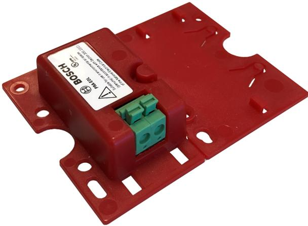
Perangkat end-of-line ini merupakan solusi andal untuk pengawasan integritas line loudspeaker, yang merupakan persyaratan untuk sistem suara darurat. Perangkat ini tersambung dengan ujung line loudspeaker, setelah loudspeaker terakhir dari serangkaian loudspeaker loop-through.
