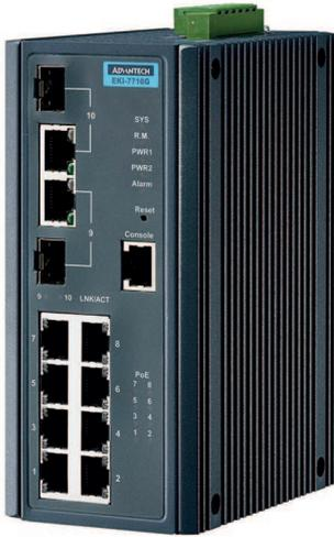
PRA-ES8P2S는 8개의 기가비트 구리선 포트가 있는 소형 DIN 레일 장착형 이더넷 스위치입니다. PoE(Power over Ethernet) 및 2개의 기가비트 SFP 콤보 포트를 지원합니다. 이 이더넷 스위치는 Bosch 전관 방송 및 음성 경보 시스템에 사용하도록 Advantech가 Bosch를 위해 제작한 OEM 스위치입니다. 이 이더넷 스위치는 PRAESENSA에 최적화된, EKI-7710G-2CP-AE 스위치의 사전 구성 버전입니다. PRA-ES8P2S는 PRAESENSA 시스템과의 조합으로 EN 54-16 인증되었습니다. PRAESENSA 시스템 컨트롤러 및 다기능 전원 공급 장치의 스위치 포트에 추가하여 사용할 수 있습니다. 이 이더넷 스위치는 장거리 광섬유 연결을 위해 더 많은 SFP 포트가 필요한 대규모 시스템에서 또는 PRAESENSA 폴 스테이션에 전력을 공급하기 위해 PoE 지원 포트가 필요한 경우 특히 편리합니다.
