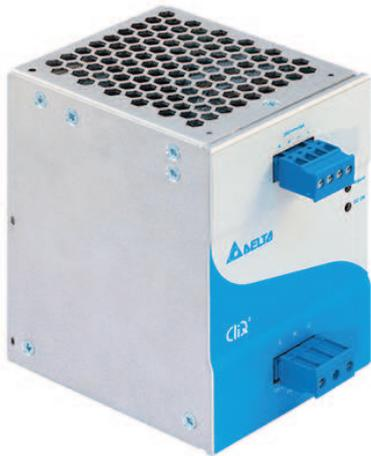
Modul catu daya PRA-PSM24 merupakan catu daya yang dipasang dengan rel DIN ringkas, mampu mengirimkan 24 V hingga 10 A secara terus-menerus. Catu daya ini merupakan catu daya OEM, dibuat untuk Bosch oleh Delta Power Supply, sebagai alternatif yang ramah biaya dibandingkan catu daya multifungsi PRAESENSA PRA-MPS3 untuk memasok daya pengontrol sistem PRAESENSA atau perangkat dan utilitas lain yang memerlukan 24 V, jika karakteristik dan fungsi tambahan catu daya multifungsi tidak diperlukan.
