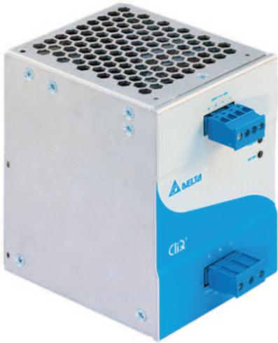
PRA-PSM48电源模块是紧凑的DIN导轨安装式电源, 可供应48 V的电压, 最大持续电流可达5 A。该电源为OEM电源, 由Delta Power Supply为Bosch制造, 非常经济实惠, 可代替PRAESENSA多功能电源PRA-MPS3, 为PRAESENSA功率放大器供电, 适合在不需要多功能电源的其他功能和特性的情况下使用。它未获得EN 54-4和相似标准的认证。
