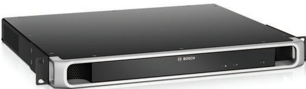
在众多系统控制器中，PRA-SCL是功能最为强大的版本。该系统控制器可管理PRAESENSA公共广播和语音报警系统中的所有与系统相关功能。它可在联网的PRAESENSA音源和目标分区之间路由所有音频连接。它可监测和播放存储在闪存上的信息和提示音，您可以预设定时播放，也可以在呼叫站或PC上手动启动。它可管理背景音乐流的路由、业务呼叫和紧急呼叫，所有这些均根据优先级和分区占用情况而定。它可收集联网系统设备的所有状态信息，管理事件日志，并报告故障。
